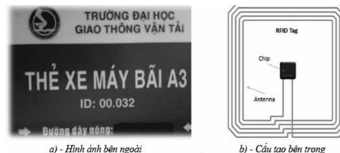
Hình 2. Hình dạng bên ngoài và cấu tạo bên trong thẻ vé xe
