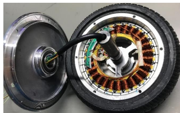
H. 4 Bánh xe cao su tự nhiên kèm động cơ không chổi than.
