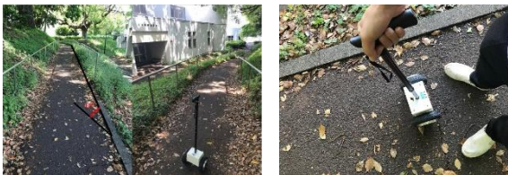
H. 10 Robot gậy hỗ trợ người sử dụng trong môi trường dốc và kém bằng phẳng.
